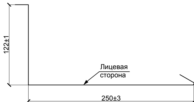
Планка примыкания нижняя ППН-250x122x2000
