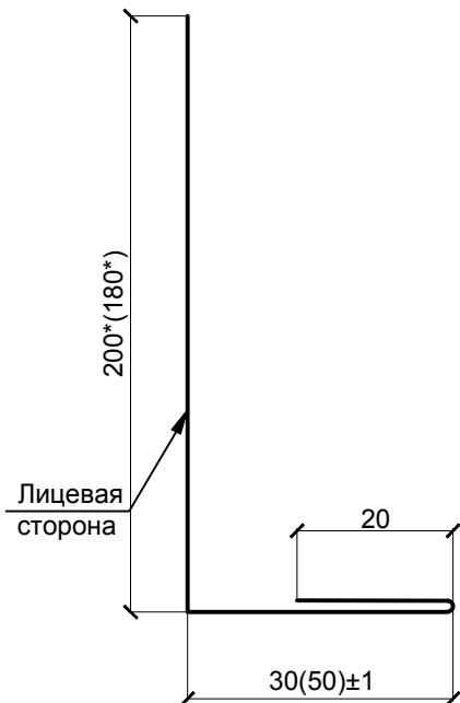
Планка карнизного свеса ПКС-180x50x2000 ПКС-200x50x2000
